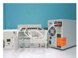
图表2-19 从USHA Card 的「局域网络」端口连接以太网络电缆
