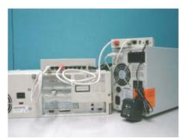
图表2-20 从USHA ProE II 的「局域网络|端口连接以太网络电缆
